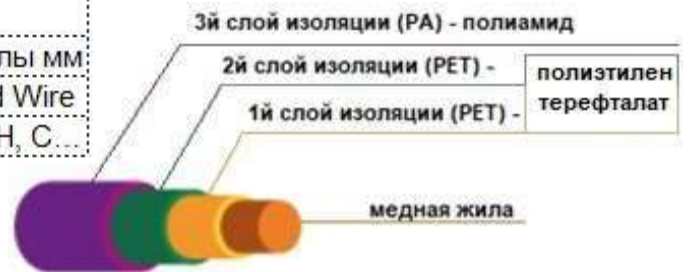
Рисунок 2. Схема изоляции провода TIW.
