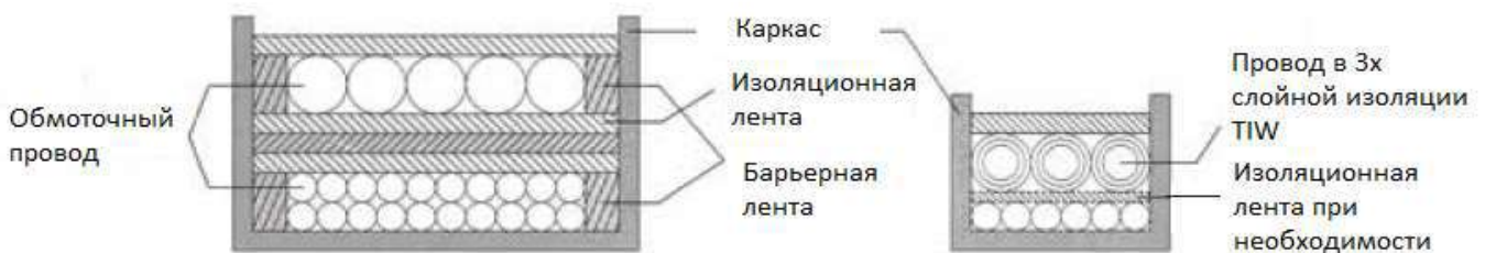
Рисунок 3. Схема намотки трансформатора обычным эмаль проводом и проводом TIW
